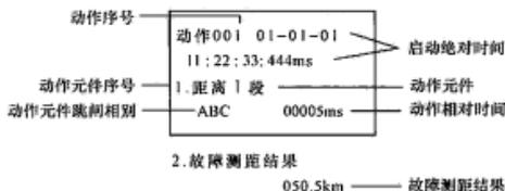
图 1-19 保护动作时液晶屏幕画面
