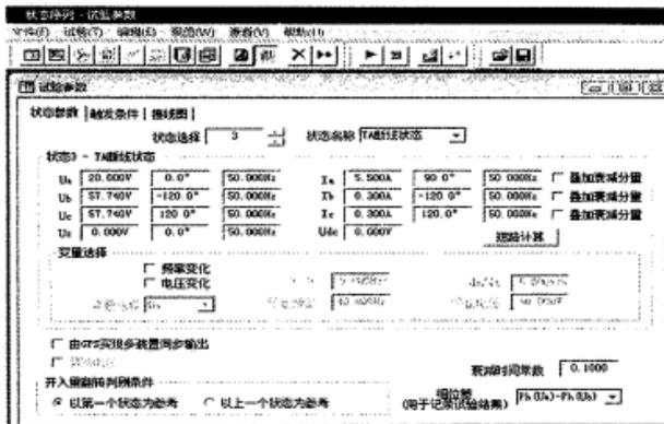
图 1-47 TA 断线后零序 II 段不带方向
