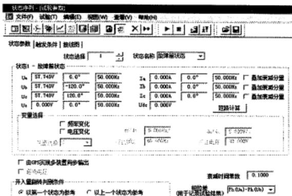
图 3-30 故障前状态(正常状态)
