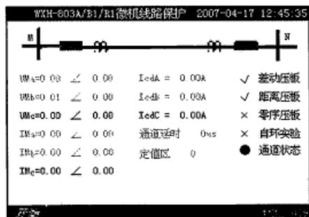
图 3-20 正常运行时液晶显示图
