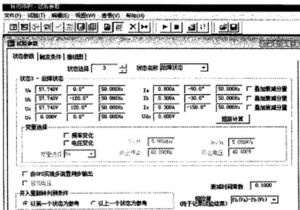
图 1-29 校验零差保护故障状态
