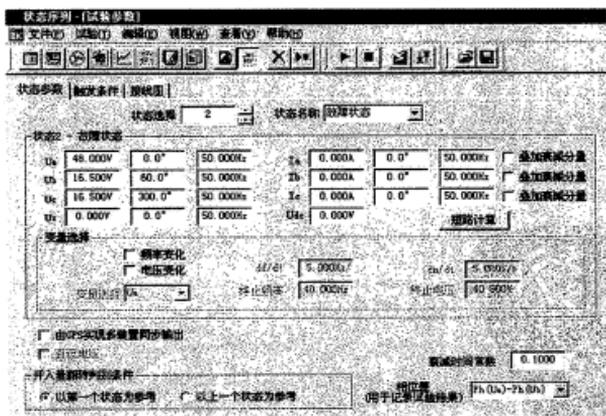
图 3-40 电压反序 ( $U_2>4U_1$ )
