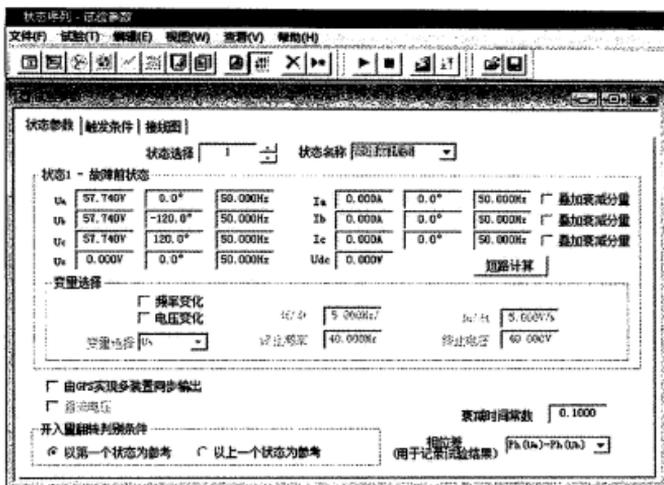
图 1-24 状态序列法正常运行状态（状态 1）电流、电压
